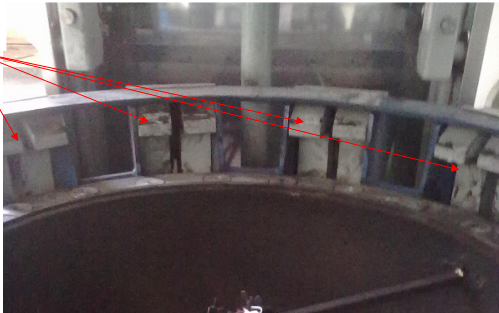
Obr. 3.6 Pohled na hydraulické čelisti zajišťující těsnost autoklávu.
