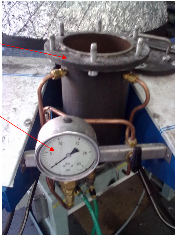
Obr. 3.9 - Pohled na zásobník rozvířovaného vzorku
