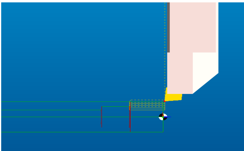
Obr. 11.4 Dráha nástroje pro výrobu levé strany součásti
