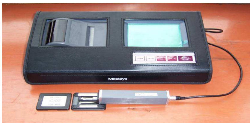
Obr. 13 Měřicí přístroj Mitutoyo SurfTest SJ-301
