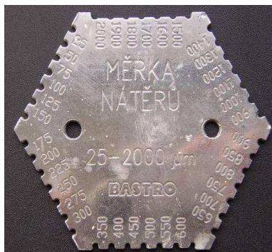
Obr.17 Měřicí hřeben BASTRO
