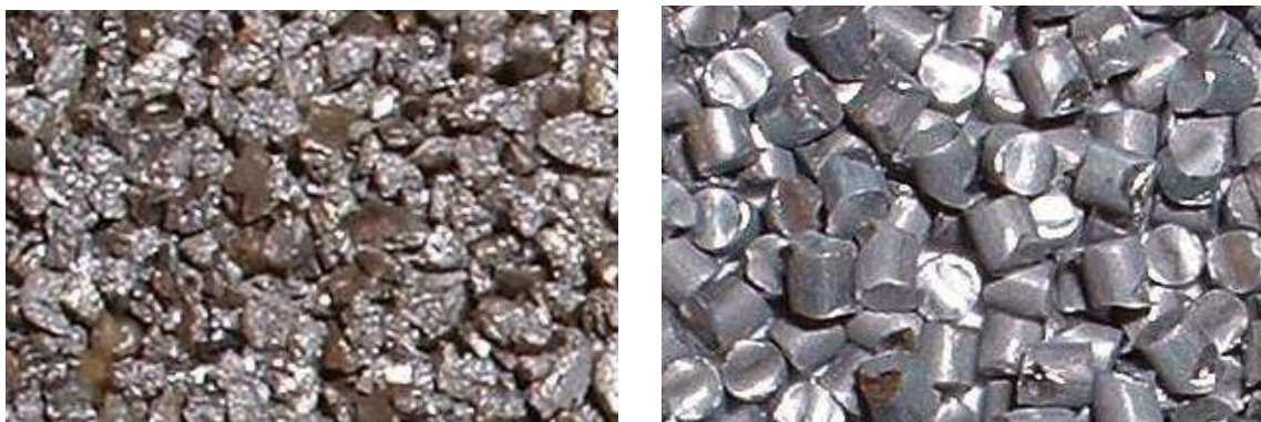
Obr. 5 Otryskávací materiál, ocelová drť a sekaný drát [30]
