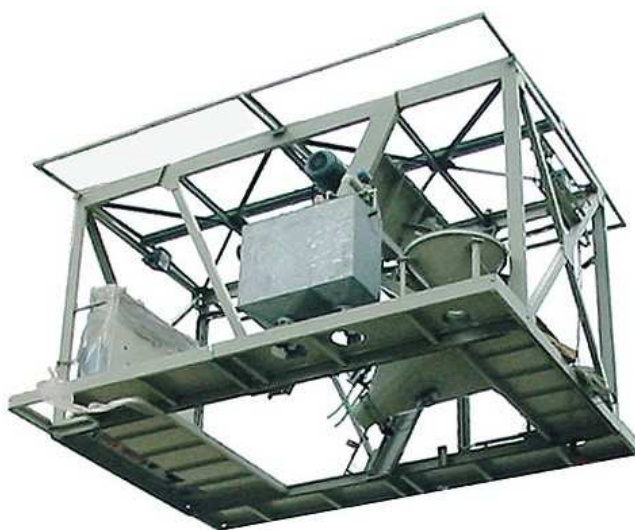
Obr. č. 10 Mísící jádro betonárny
