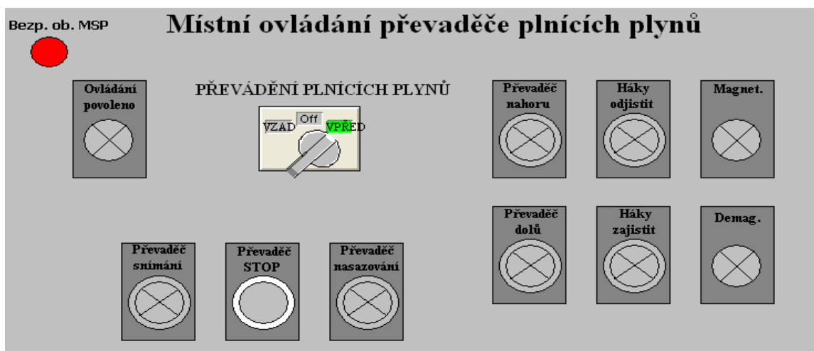
Obr. 5. Ovládání převaděče plnicích plynů
