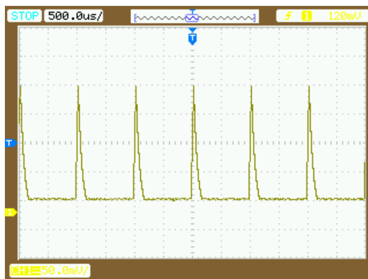
Obr. 35 – Zrealizovaný ISO7637-2 TP2a
