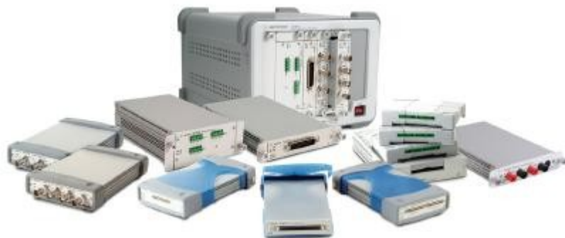
Obr. 15 – USB rám Agilent U2781A spolu s různými moduly [10]
