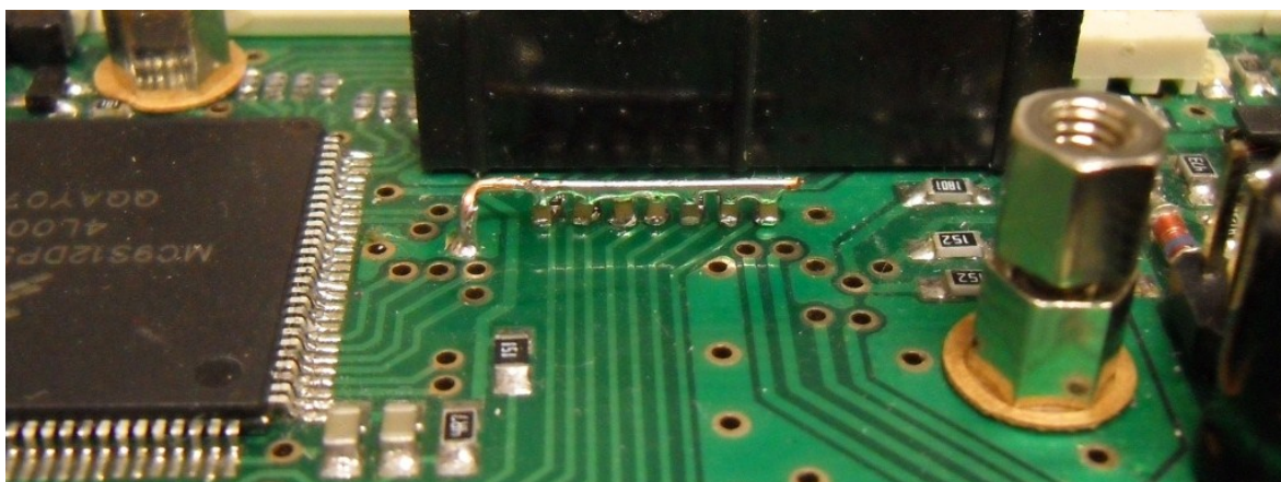
Obr. 13 Fotografie doplnění kondenzátorů pro měření napětí
