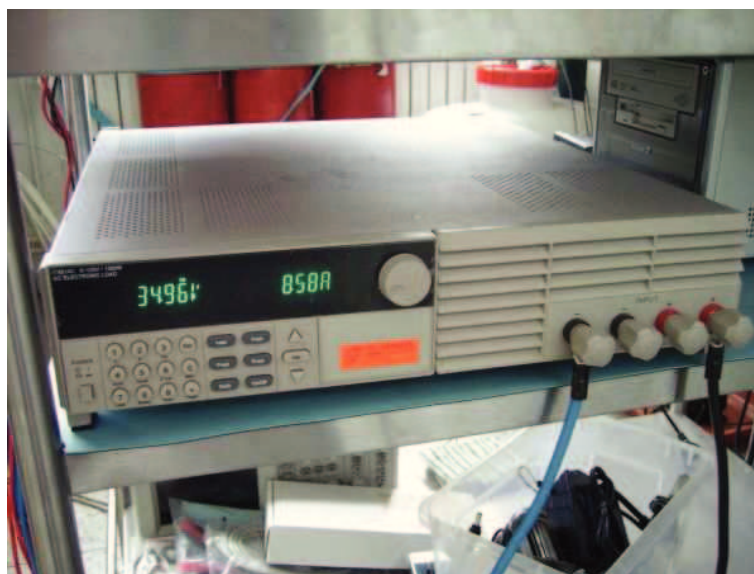
Obrázek 38: DC zátěž Electronic load IT8514C
