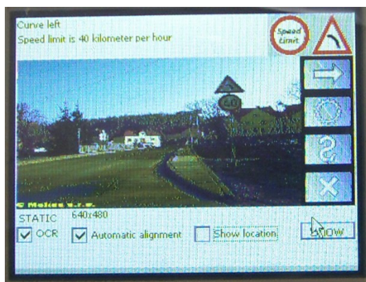
Obr.33. Obrazovka s rozpoznáním dopravním značením
