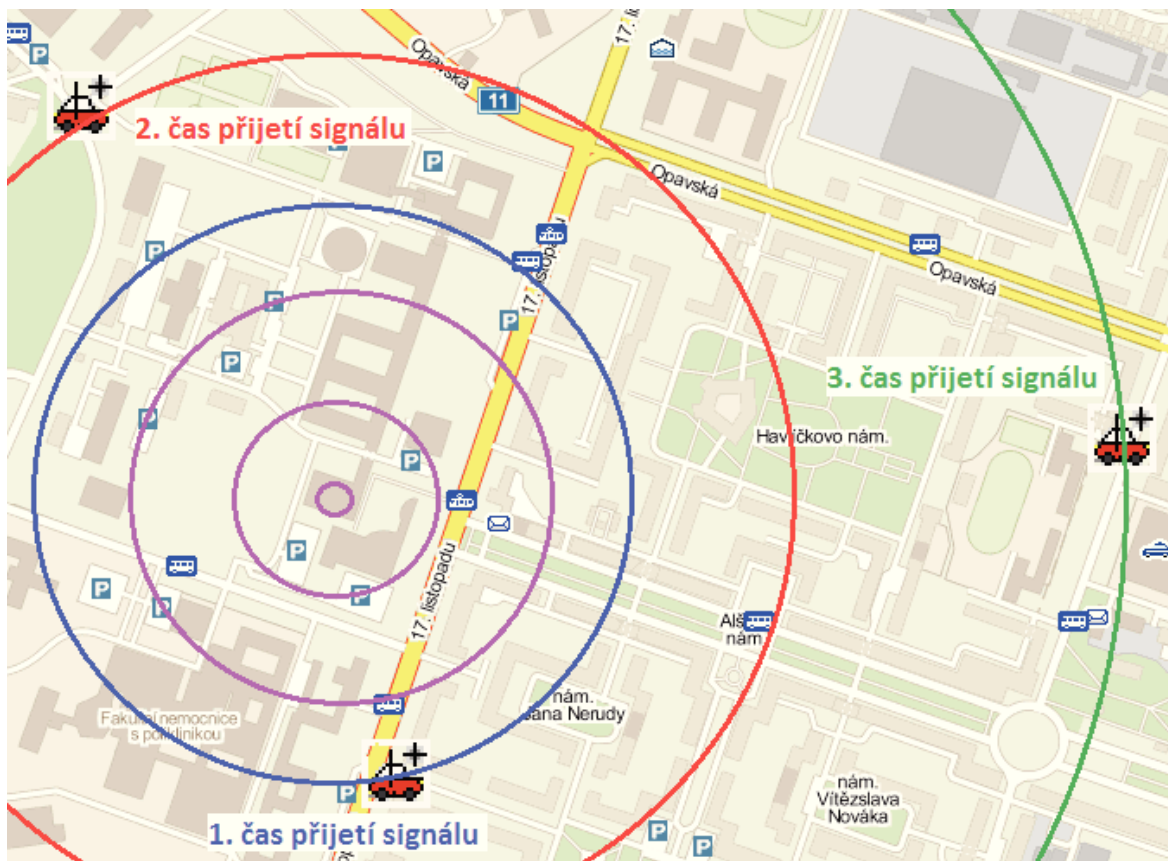
Obrázek 2-10: Příklad zaměřování pozice zdroje signálu.
