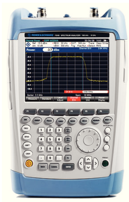
Obrázek 2-4: Ruční spektrální analyzátor R&S®FSH8
