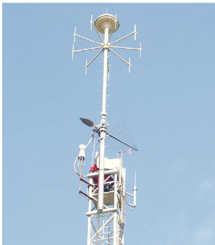
Obrázek 2-9: Stabilní zaměřovací jednotka ČTÚ.
