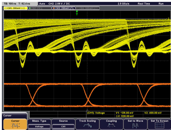
Obrázek 49 Diagram oka při rychlosti 3\text{Mbit}\cdot\text{s}^{-1}
