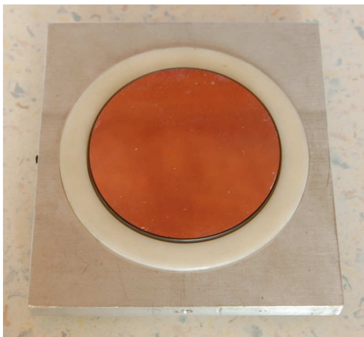
Obrázek 43 Namontované zrcadlo v objímce
