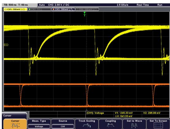
Obrázek 47 Diagram oka při rychlosti 0,5\text{Mbit}\cdot\text{s}^{-1}
