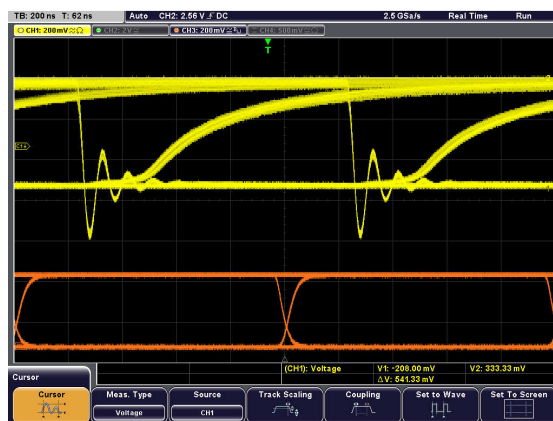
Obrázek 48 Diagram oka při rychlosti 1\text{Mbit}\cdot\text{s}^{-1}
