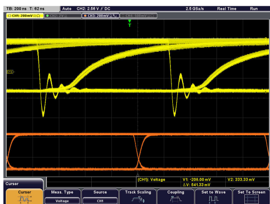
Obrázek 52 Diagram oka při rychlosti 1\text{Mbit}\cdot\text{s}^{-1} bez vzduchových turbulencí
