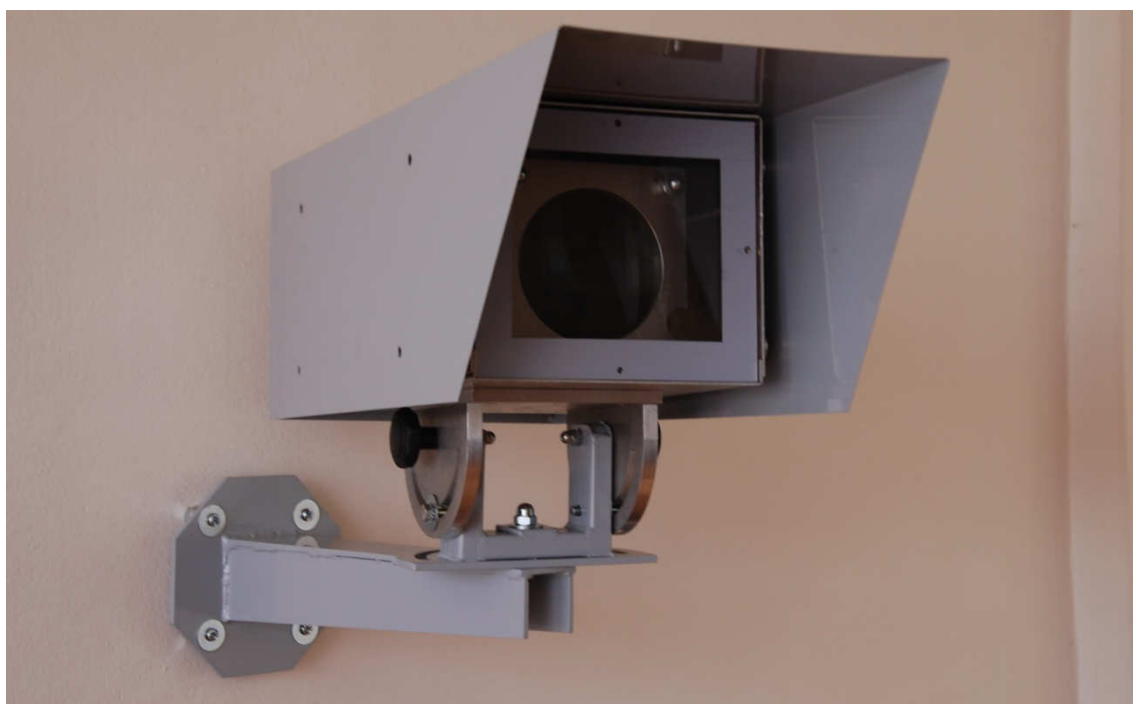
Obrázek 22 Konstrukce hlavičky detektoru a laseru
