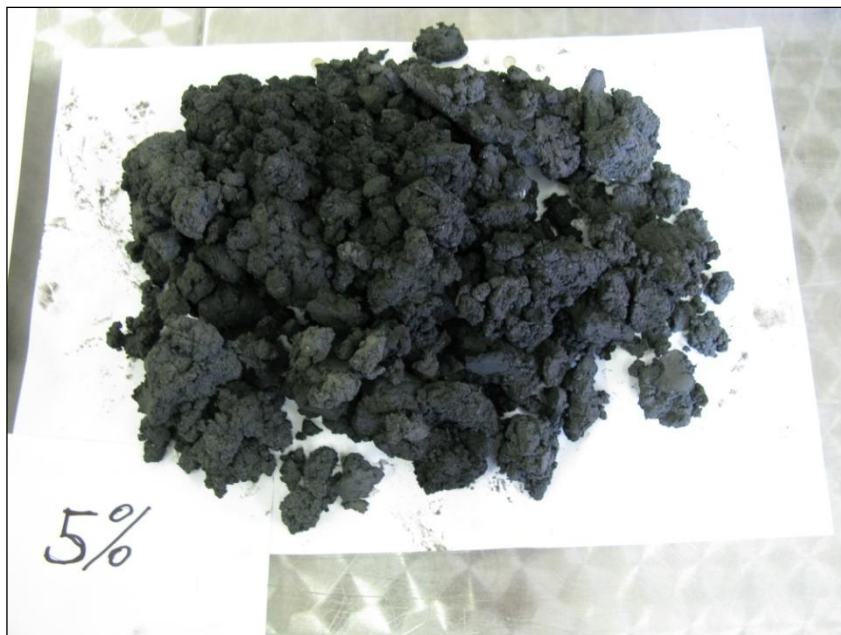
Obrázek č. 11: Směs uhelného kalu a 5% CaO
