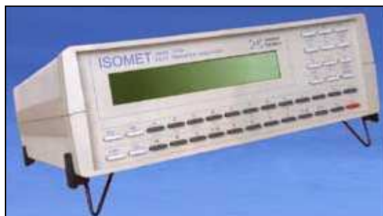
Obr. 9. Isomet 2104 pro stanovení tepelná vodivosti
