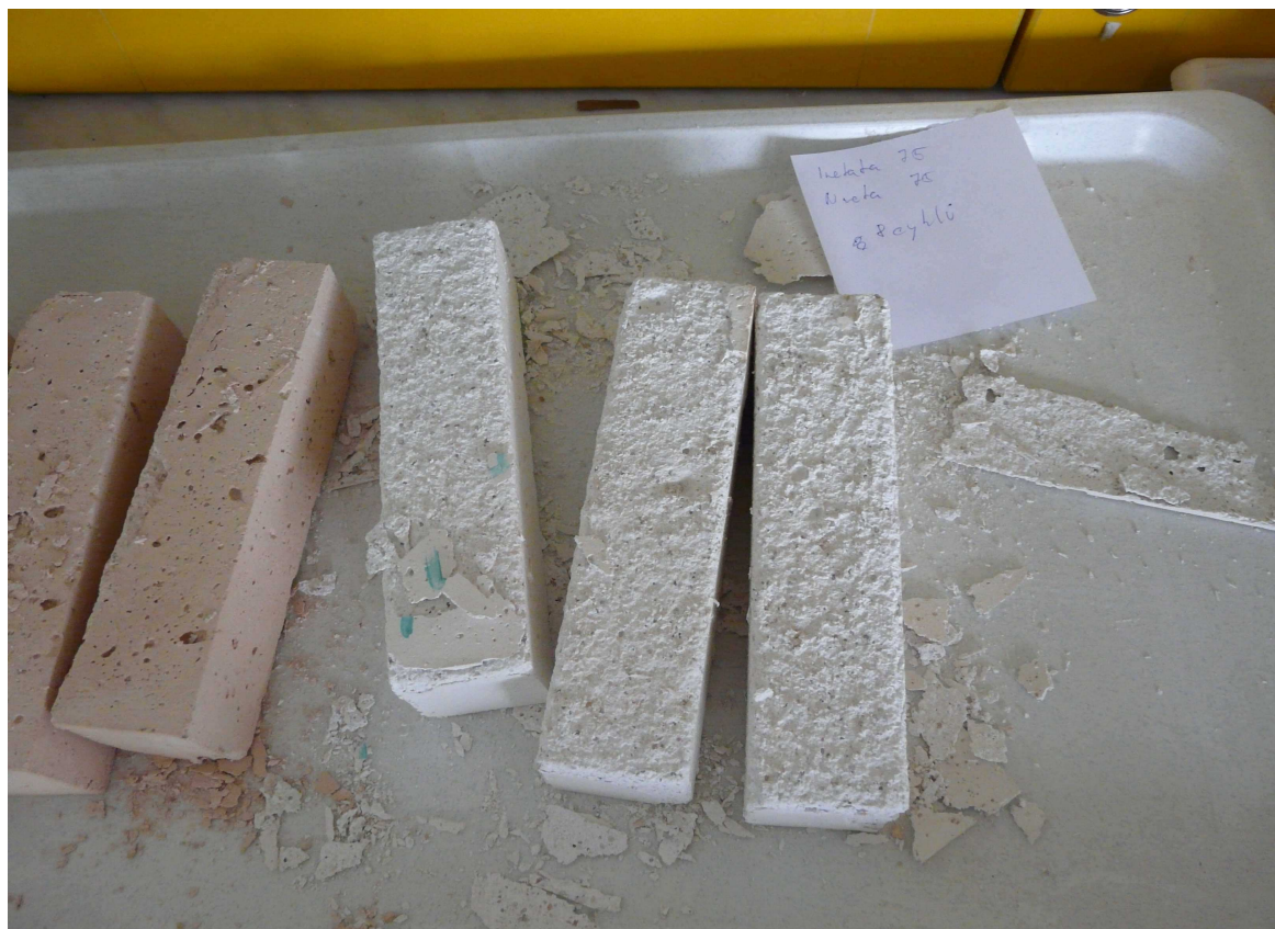
Obr. 47. Šupinové porušení povrchu těles při zkoušce mrazuvzdornosti(Nmeta + 75% experlitu)
