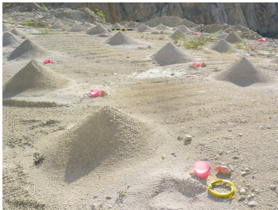
Obr.4: Vrty v Čachtickom kameňolome pred odstreloom
