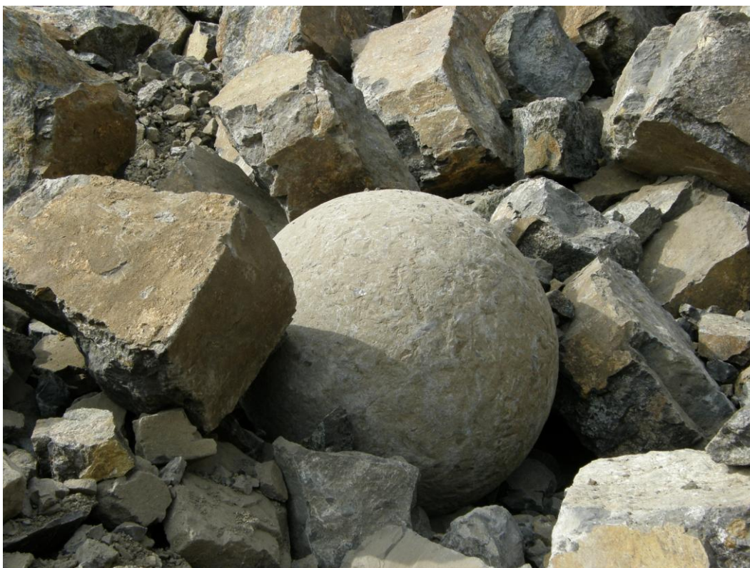
Obrázek č. 10: Rozbití nadměrných kusů rubaniny ocelovou koulí
