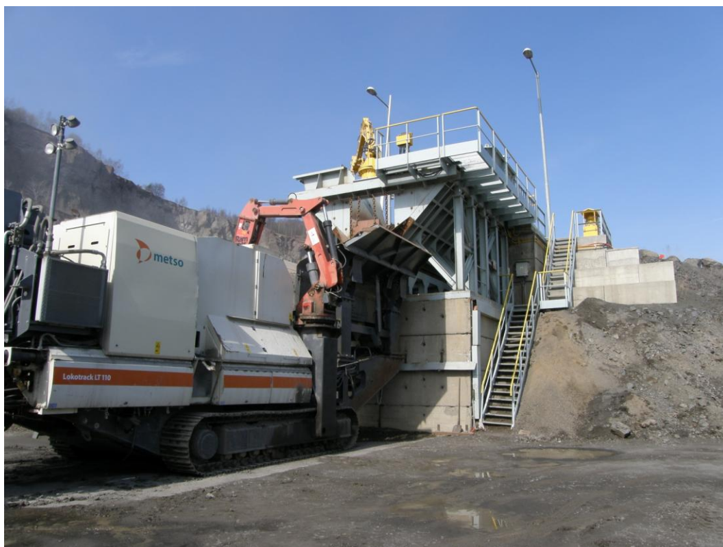
Obrázek č. 18: Mobilní zařízení LOCOTRACK LT 110 S/N zařazené do hlavního výrobního celku
