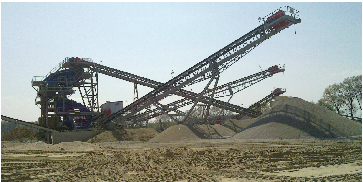
Obrázek č. 6 Úpravna kameniva Polešovice o výkonu až 350 tun za hodinu
