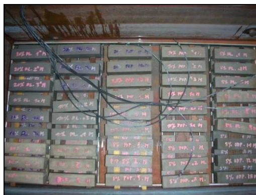
Obr. č. 14 – Zkouška mrazuvzdornosti
