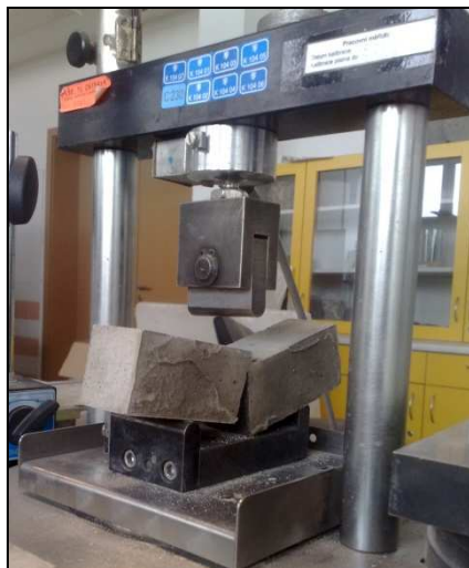
obr. č. 12 – Zkouška pevnosti v tahu ohybem
