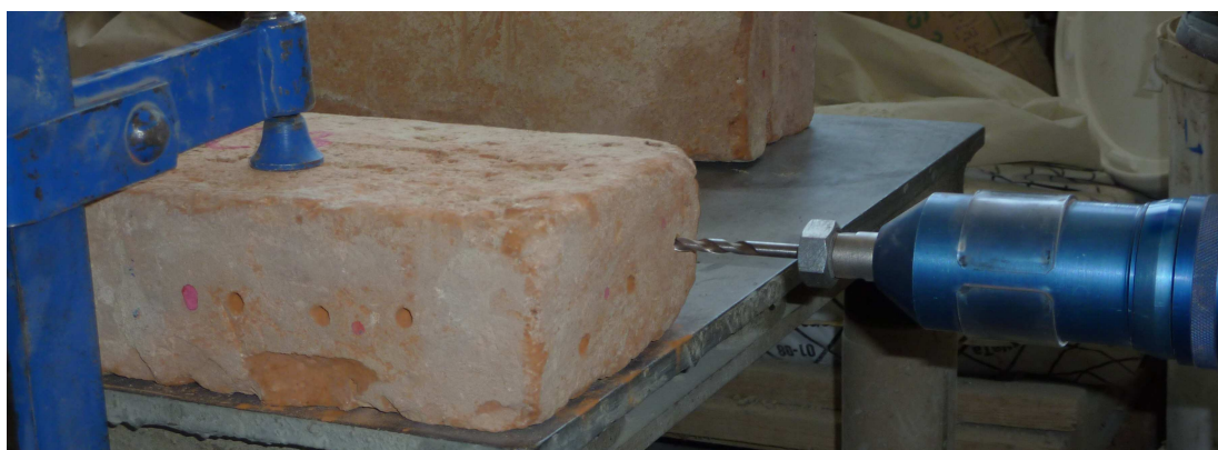
obr. č. 5.3 – Provádění vývrtů do cihly Kučerovou vrtačkou PZZ 01
