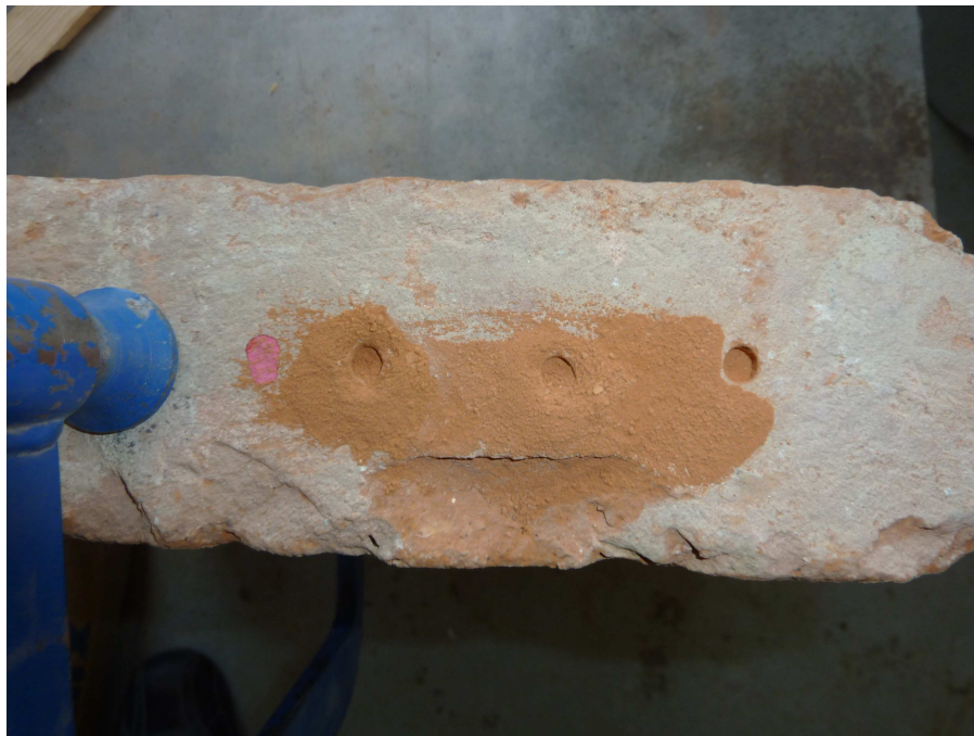
obr. č. 5.5 – Vyvrtané otvory Kučerovou vrtačkou PZZ 01
