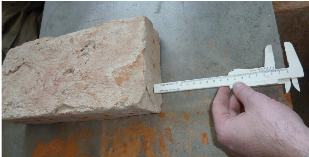
obr. č. 5.4 – Měření hloubky vrtu posuvným měřidlem
