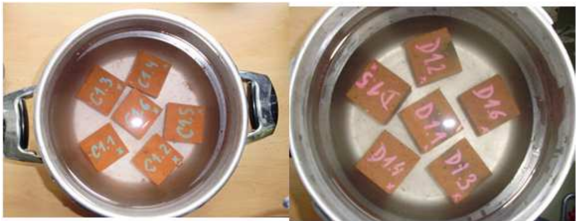
obr. č. 5.7 – Zkušební tělesa připravené na zkoušku nasákavosti
