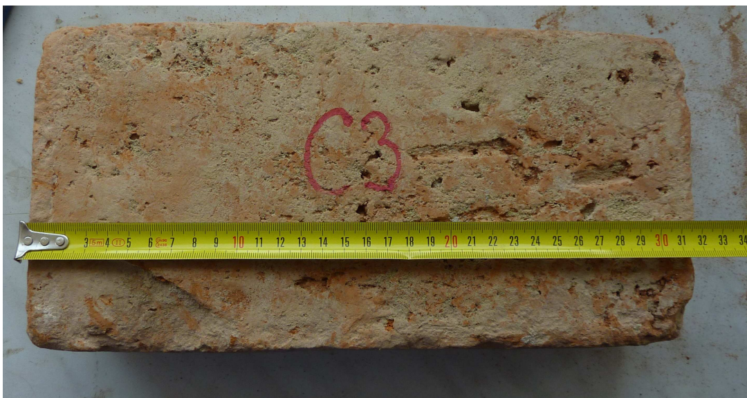
obr. č. 5.1 - Měření rozměrů cihly
