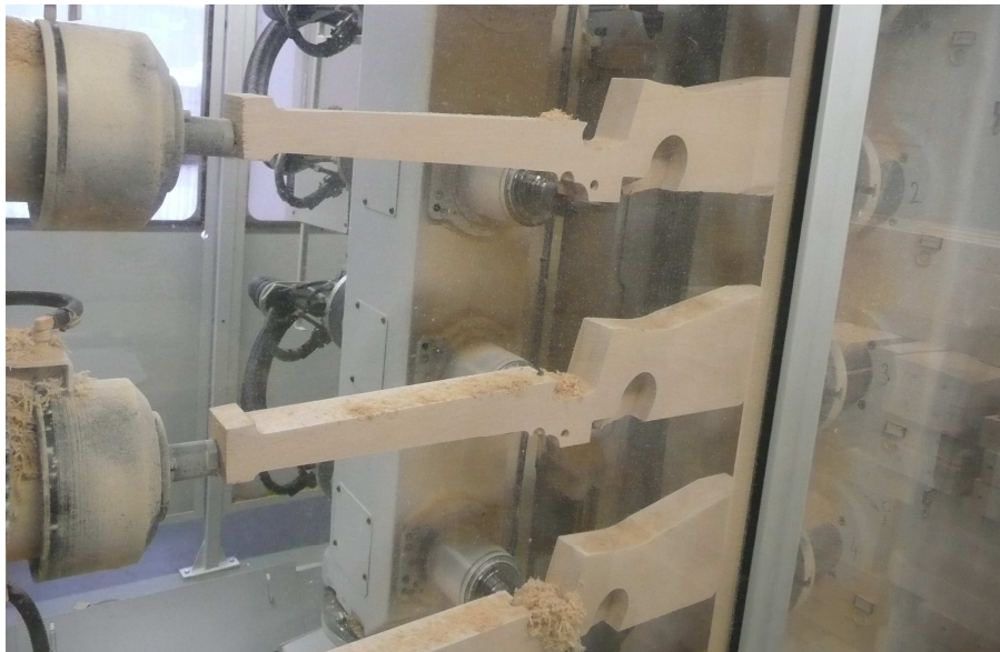
Obrázek 3.4 Obráběcí centrum CNC s otočnými upínači [vlastní]
