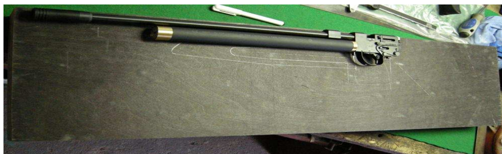
Obrázek 3.10 Přenesení rozměrů na materiál [vlastní]
