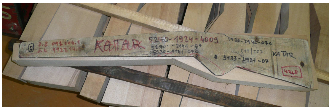
Obrázek 3.1 Hrubý výřez pažby s šablonou [vlastní]
