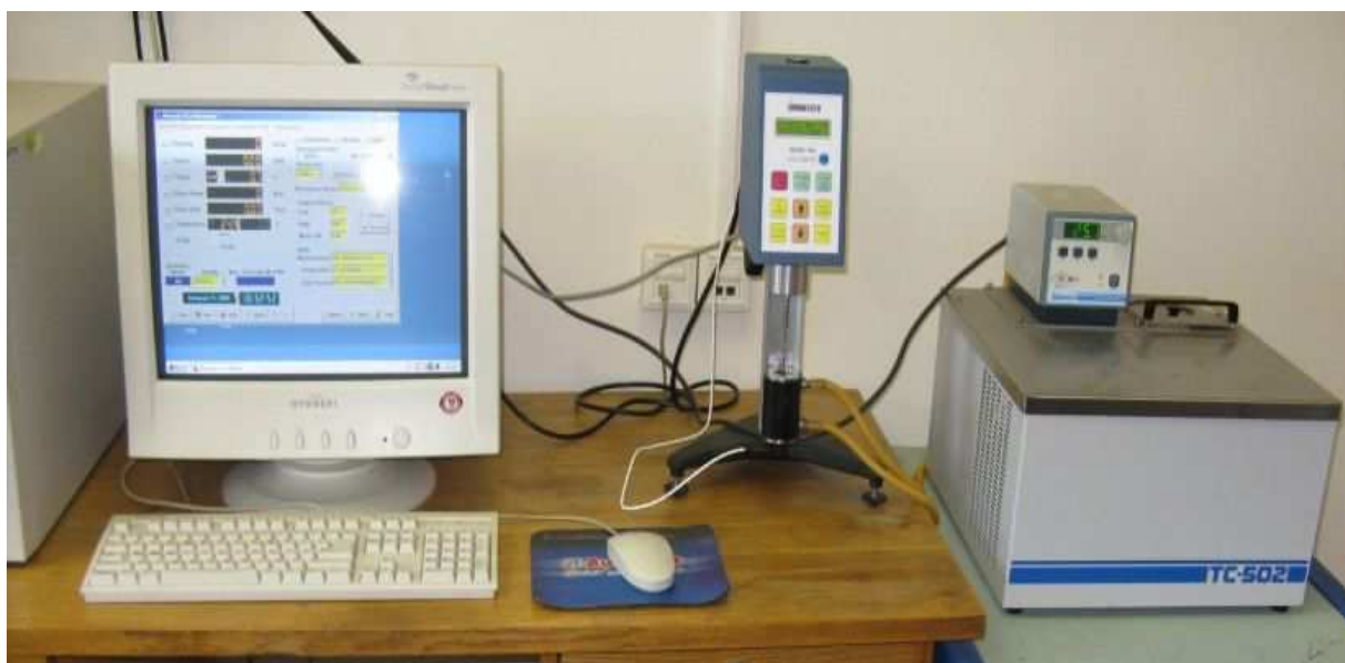
Obr. 3.3.1 Počítač se spuštěným programem Rheocalc V2.5, programovatelný reometr fy Brookfield, adaptér na malé vzorky, zařízení TC 502 pro temperaci vzorku
