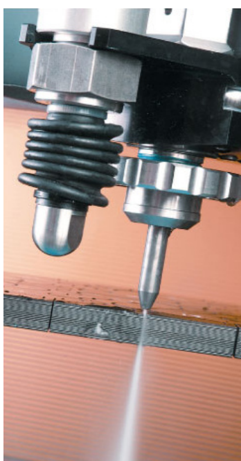
Obr. 2.3 Řezání čistou vodou
