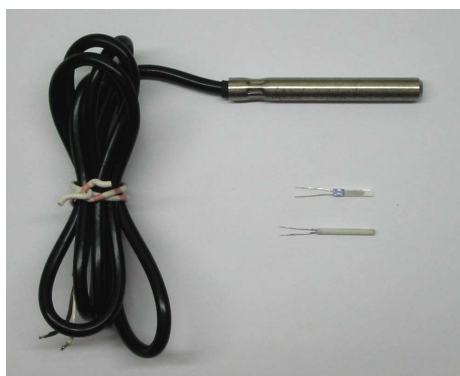
Obr. 13 Příklady odporového teploměru Pt100
