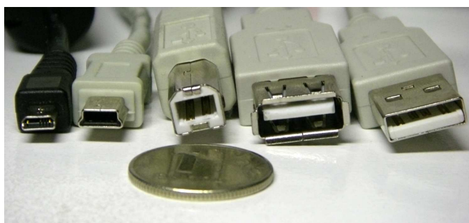
Obr. 5 Různé typy konektorů USB, zleva doprava: micro USB, mini USB, typ B, samice typ A, typ A, pro srovnání velikosti na obrázku s jedním rublem [Wikipedie USB]
