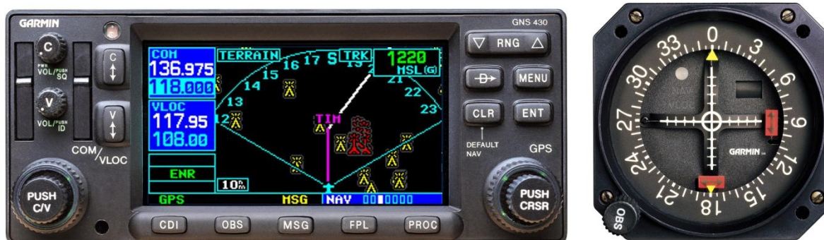
Obr.7.2 – Panel systému GNS-430W a jeho indikátor GI-106A [23]
