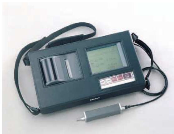
Obr.15 Příklad přístroje Mitutoyo Surftest SJ 301 [15]
