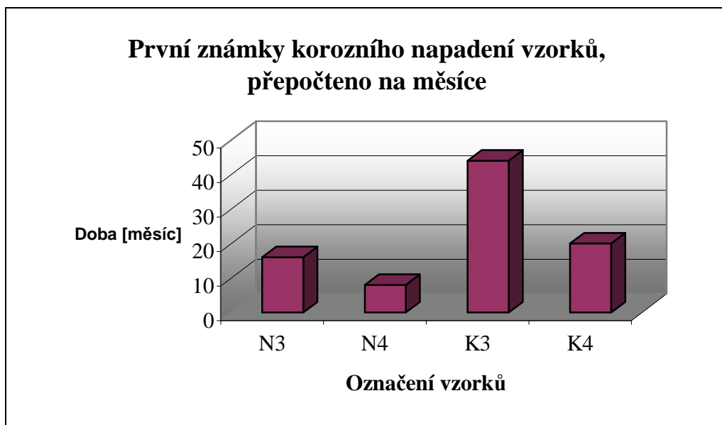
Graf č.5 První známky korozního napadení vzorků, přepočteno na měsíce v prostředí C5
