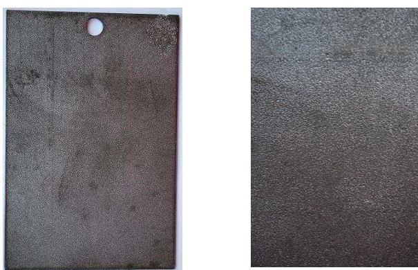
Obr.8 Fotodokumentace referenčního vzorku (N5) před odmašťováním a detail jeho povrchu
