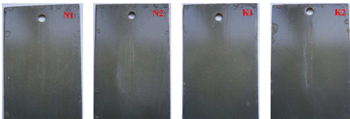
Obr.35 Fotodokumentace zrychlené ponorové zkoušky 1. cyklus vzorku N1, N2, K1 a K2
