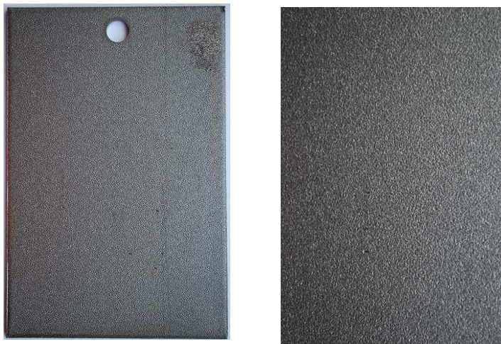
Obr.10 Fotodokumentace referenčního vzorku po odmaštění a detail jeho povrchu
