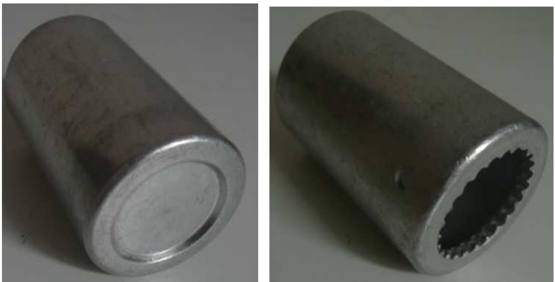
Obr. č. 4.1 Reálný polotovár a hotový výrobek
