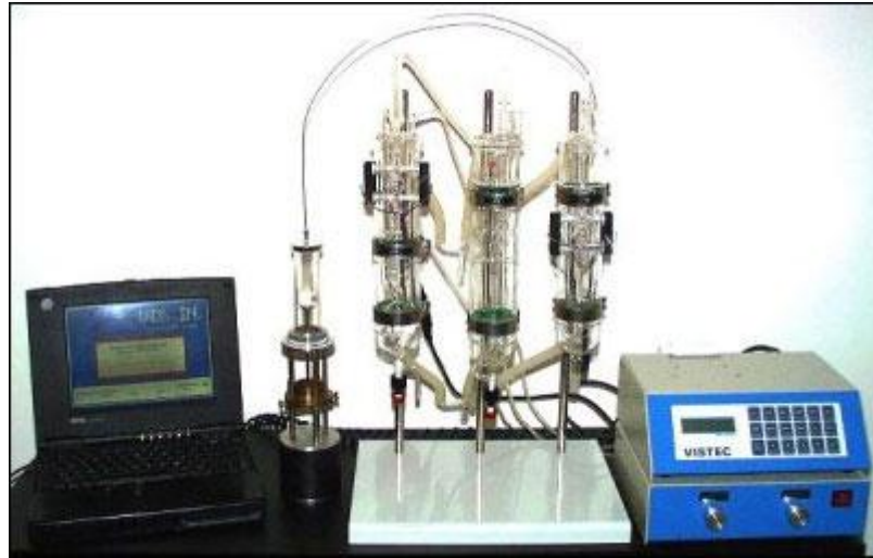
Obr. 4.2 Sestava pro měření kinematické viskozity [7]
