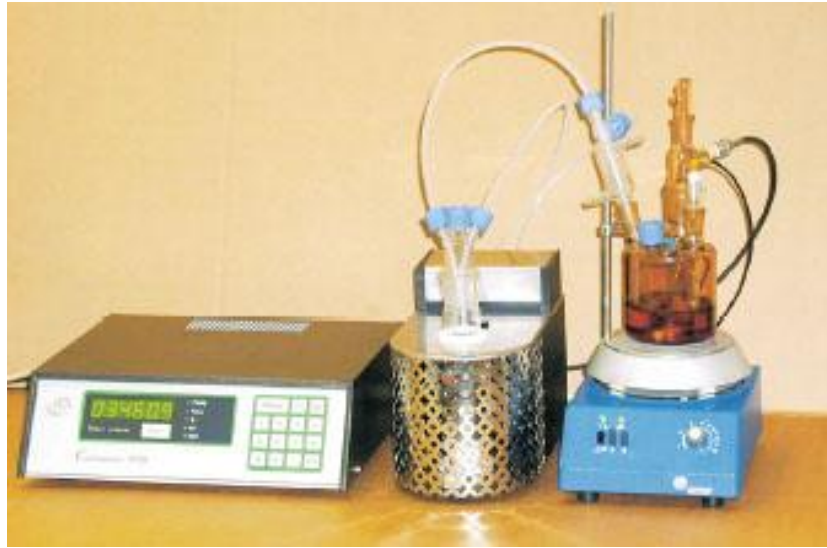
Obr. 4.4 Sestava pro určení obsahu vody [9]
