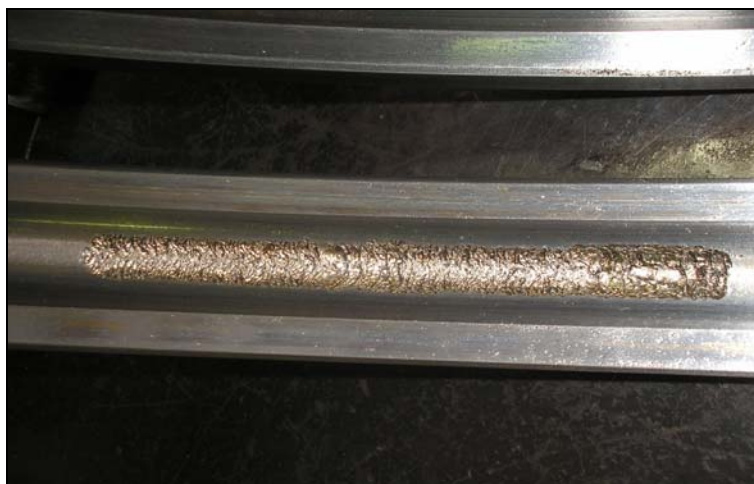
Obr. č. 17 Poškození dráhy valivého ložiska
