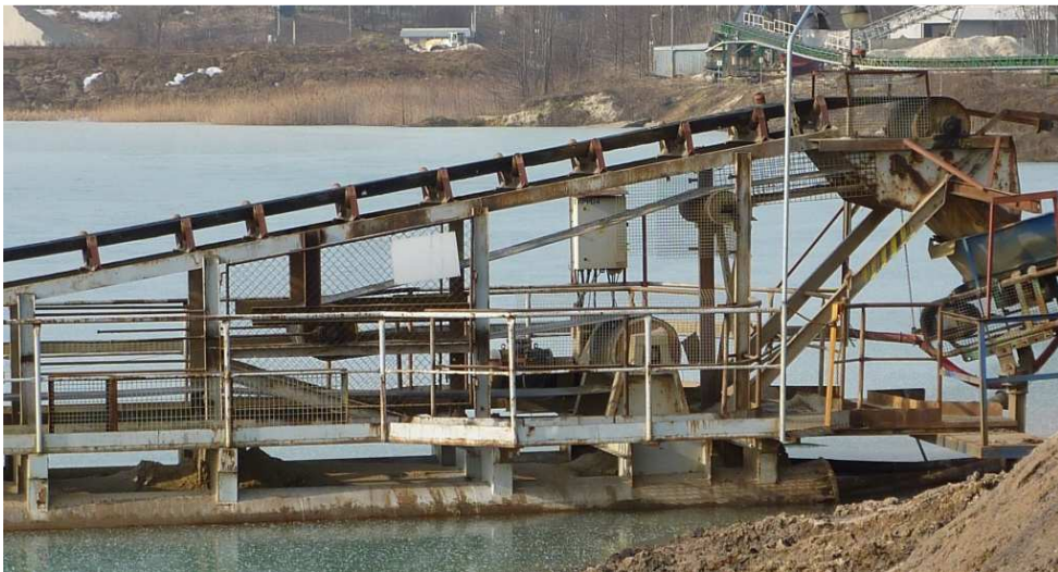
Obr. 1.4 – Plávajúci pásový dopravník s pozdĺžnym plavákovým telesom, zdroj: vlastné foto
