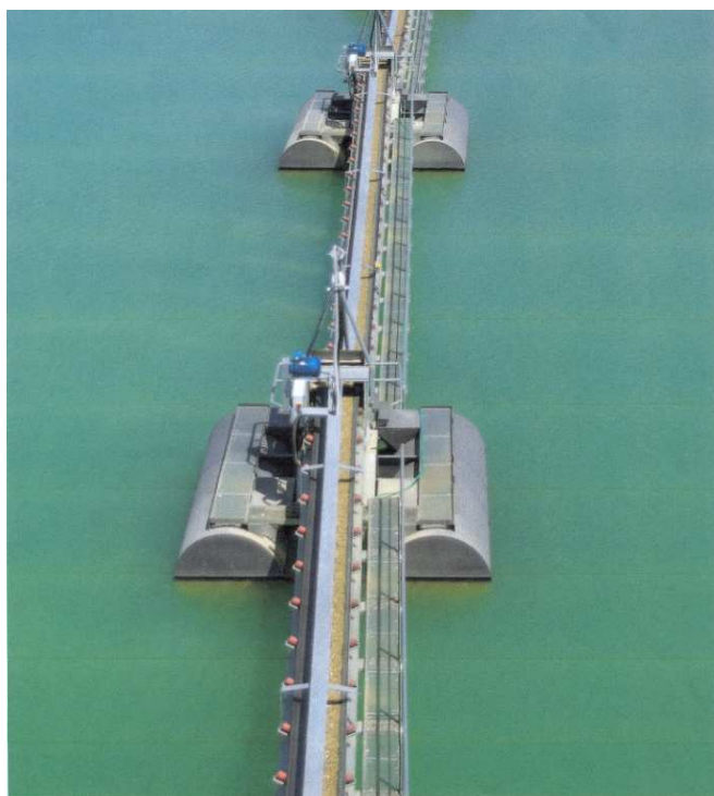
Obr. 1.5 – Plávající pásový dopravník s jednotlivými plavákovými telesami, zdroj: vlastní foto
