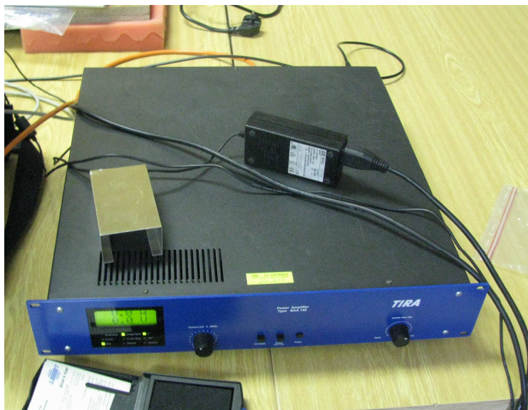
Obr. 3.4 – Výkonový zesilovač TIRA BAA 120
