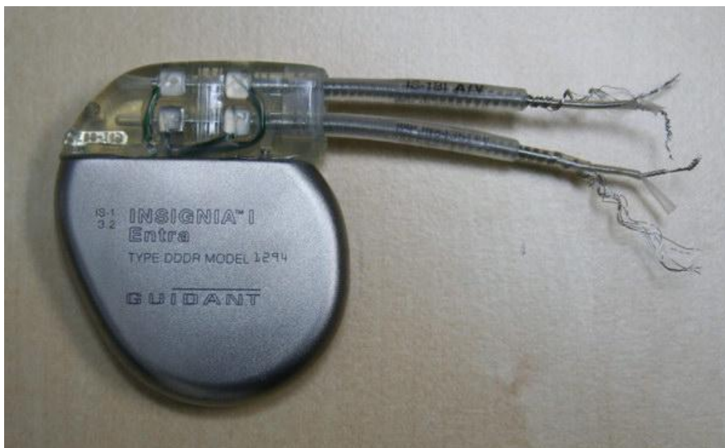
Obr. 8 Kardiostimulátor Guidant INSIGNIA™ I Entra 1294 DDDR
