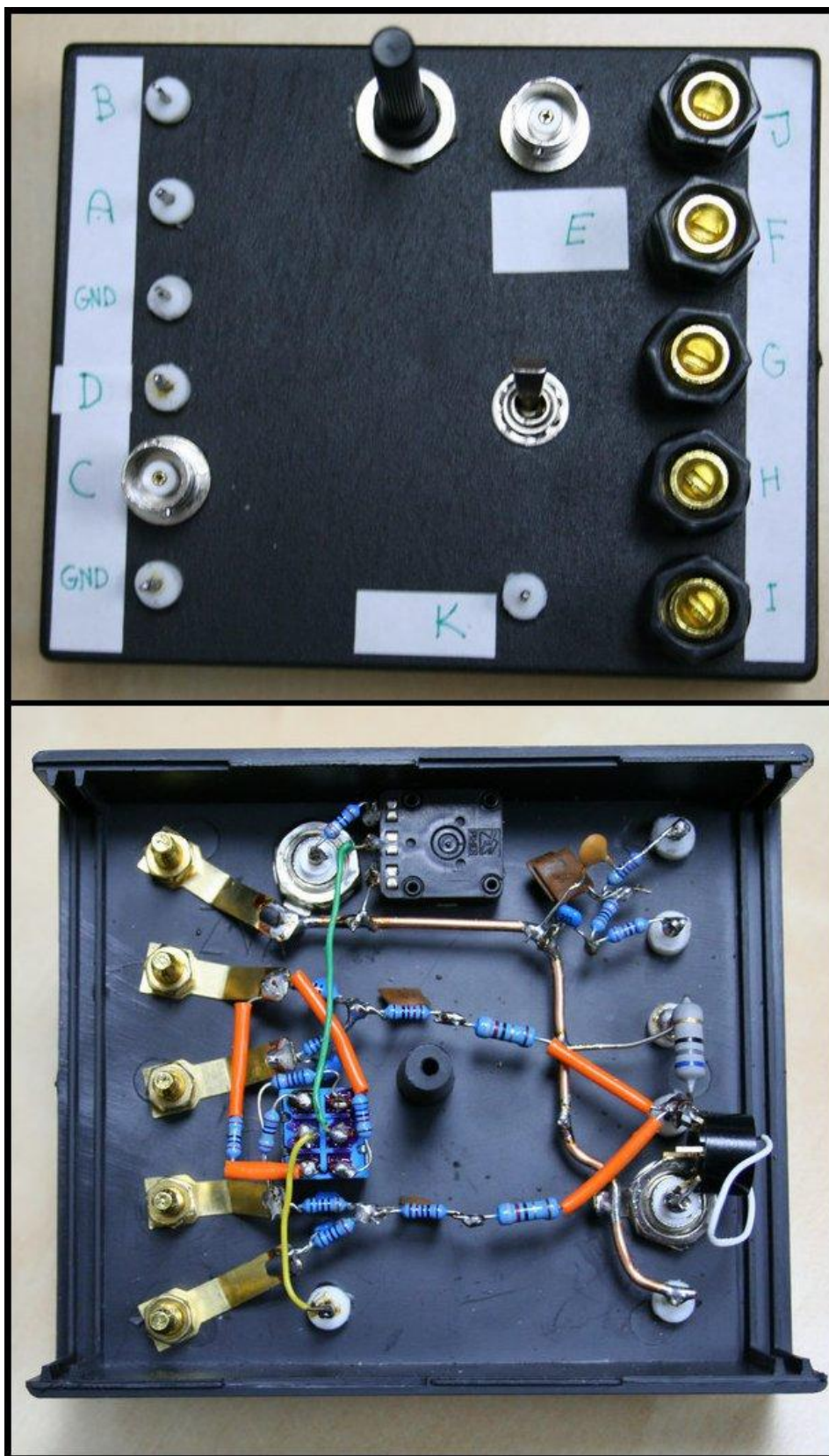
Obr. 7 Realizace obvodu náhradní tkáňe
