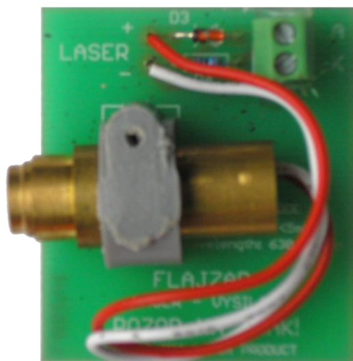
Obr. 6: Osazená deska vysílače
