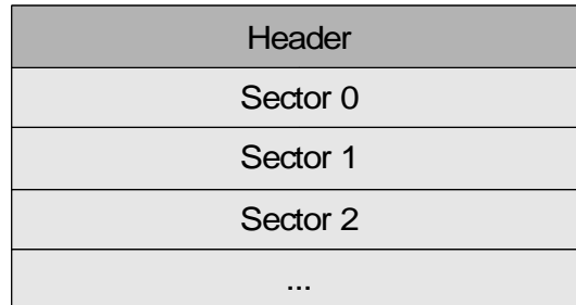
Obrázek 15: Rozdělení MCD na hlavičku a sektory
