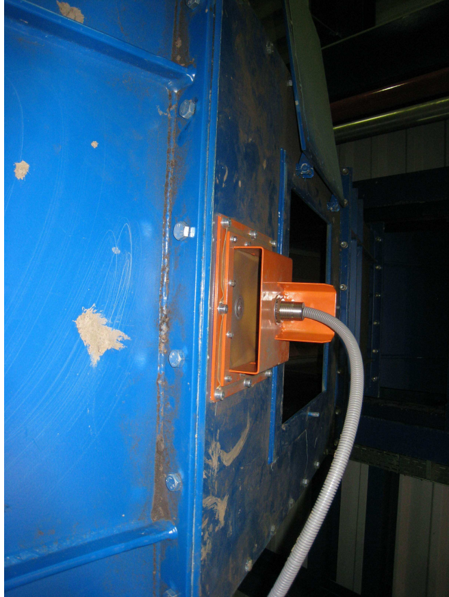
Obr. 9 Indukční snímač zahlcení přesypu typ 871TM-BH10N30-A2
