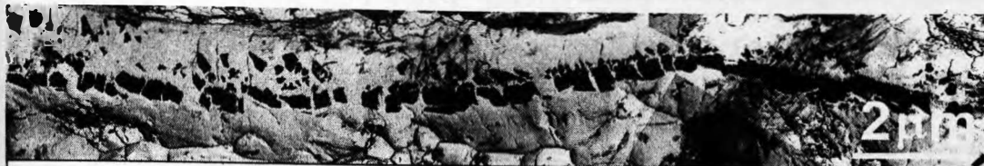
Obr. 3 Extrakční uhlíková replika filmu nitridu hliníku v protáhlé jamce lasturového lomu (TEM)
