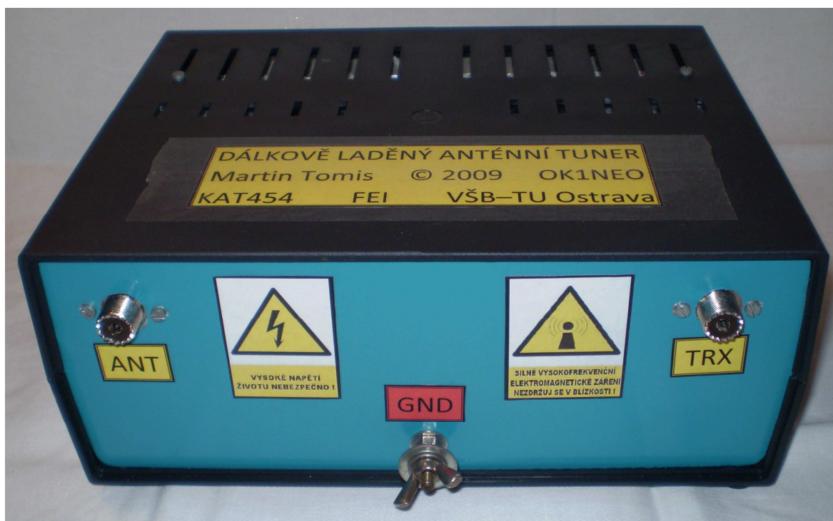
Obr.3.12: Zhotovený prototyp dálkově laděného anténního tuneru.
