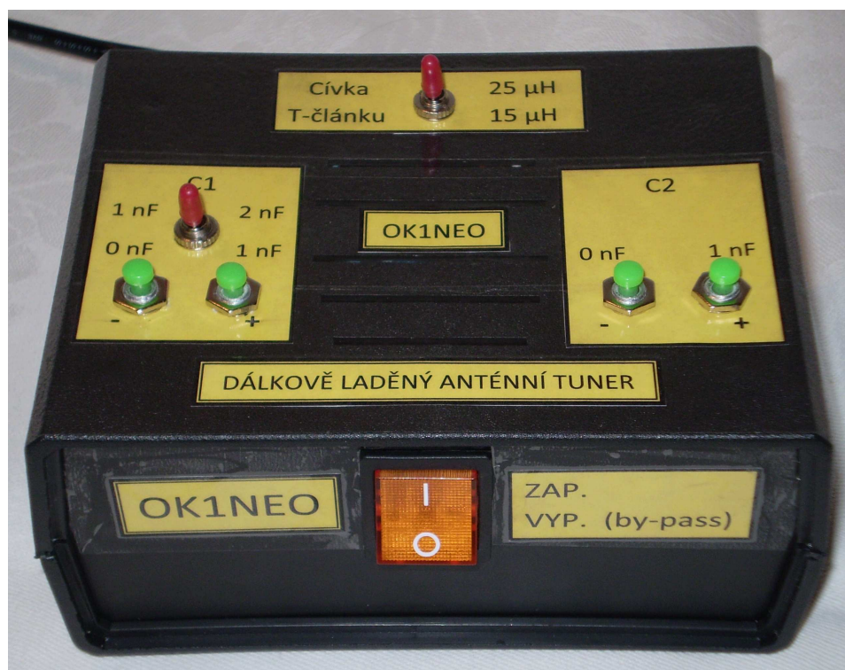
Obr.3.13: Zhotovený prototyp ovladače dálkově laděného anténního tuneru.
