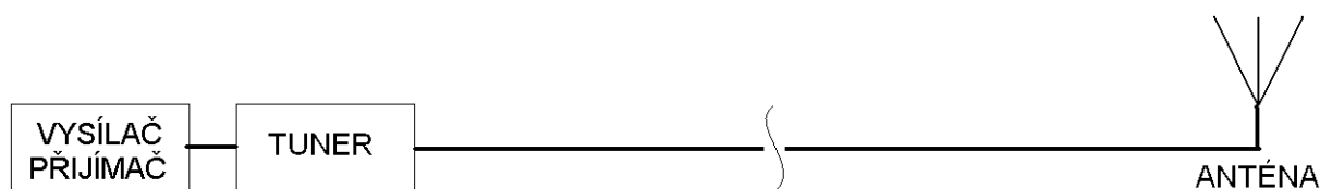
Obr.2.2: Běžné zapojení anténního tuneru na koaxiálním vedení
