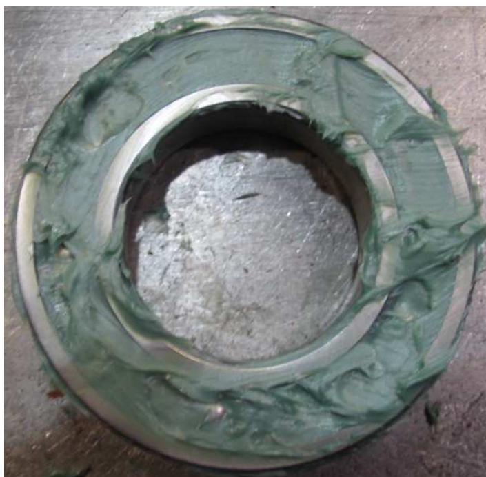
Obrázek 4 Zcela zaplněné ložisko mazivem
