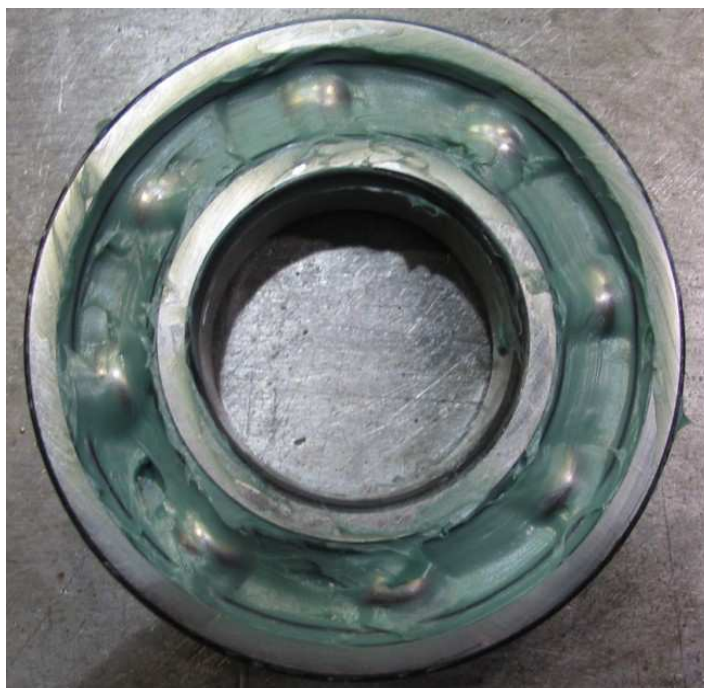
Obrázek 3 Ložisko namazané z 30%
