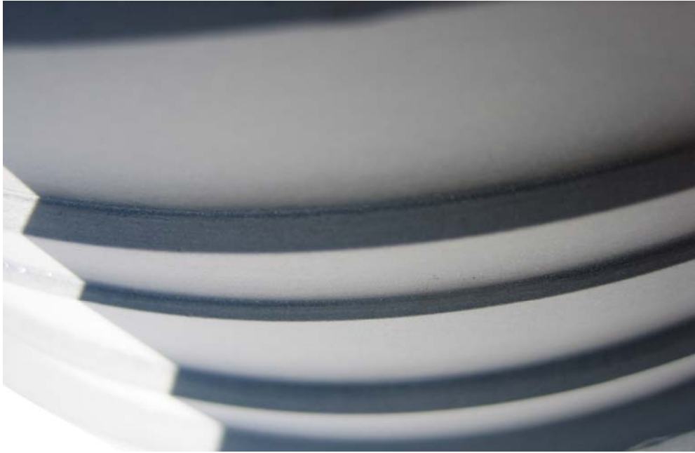
Obr. č.15 Hrany zkoušek 3+4+5 při měření řezné rychlosti na kvalitu materiálu.
