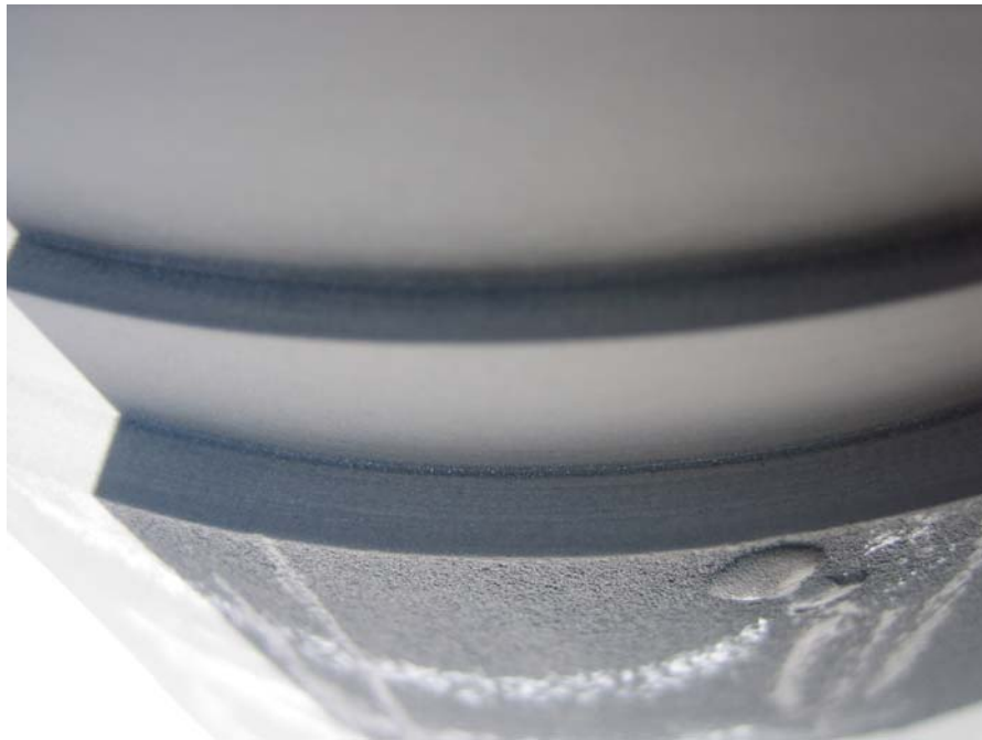
Obr. č.16 Hrany 6+7 zkoušek při měření řezné rychlosti na kvalitu materiálu.
