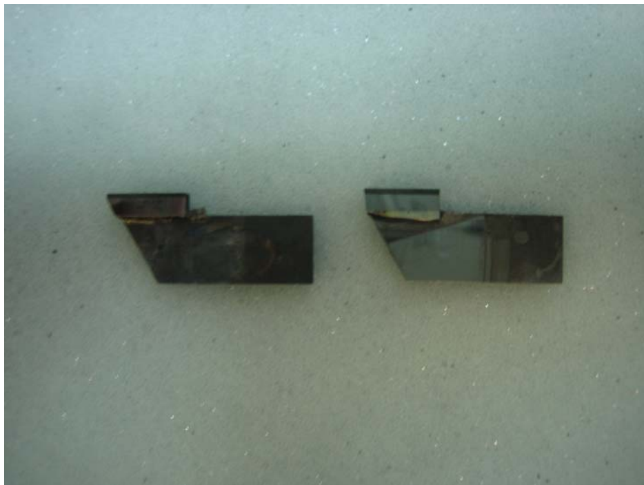
Obr. č.10 nůž CER PRAM – typ 2. Vlevo opotřebený vpravo neopotřebený.
