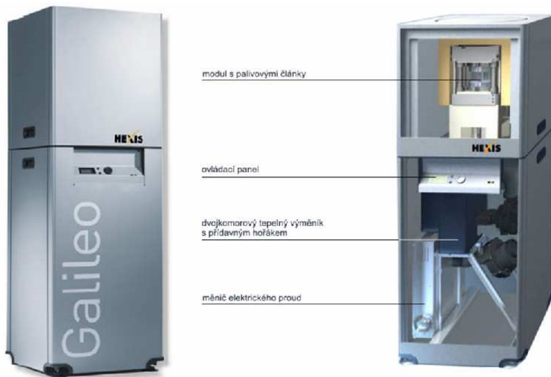
Obr. 5 - Rozmístění hlavních částí jednotky Galileo 1000 N [11]
