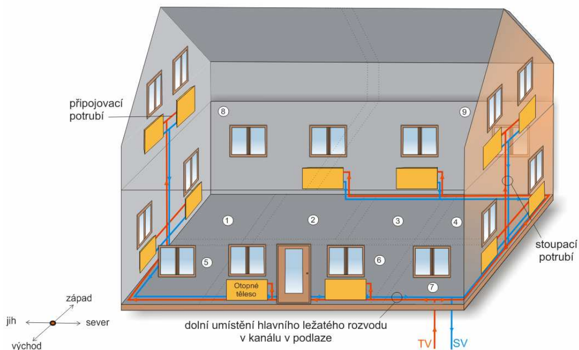
Obr. 10 - Návrh otopné soustavy v rodinném domě
