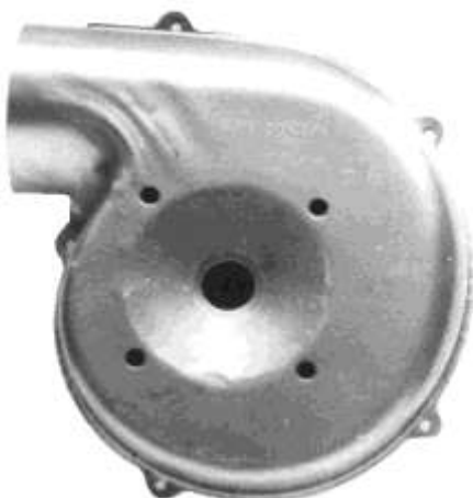
Obr. 7.9 Zvlnění na výtažku levého krytu ventilátoru ve směrech IV a V deformační síť
