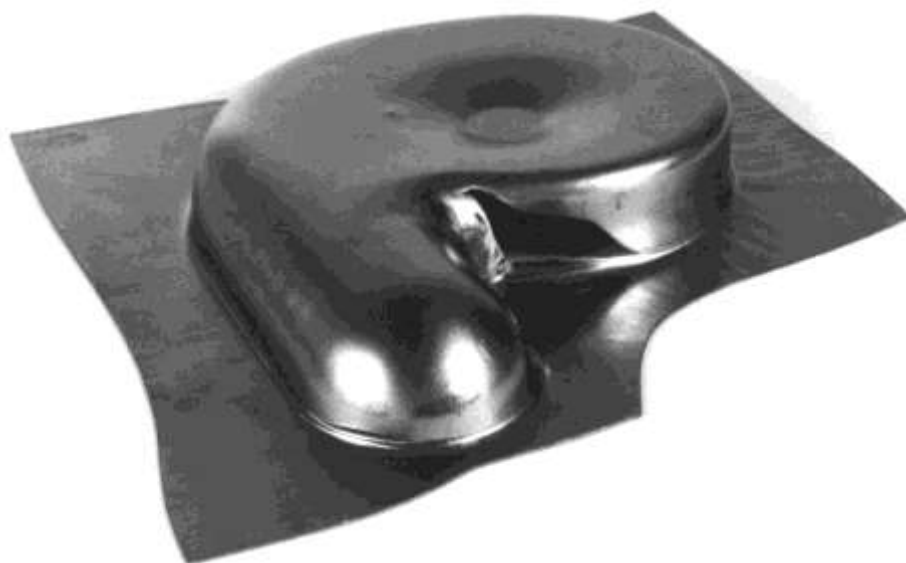
Obr. 6.22 Levý kryt ventilátoru s prasklinou blízko poloměru 12 mm
