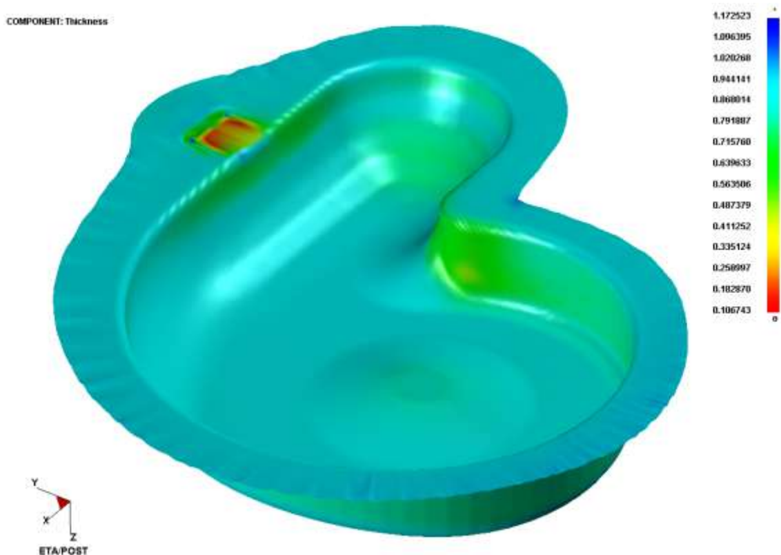
Obr. 8.9 Analýza tloušťky výtažku taženého z optimálního přístříhu z oceli DC04 při použití brzdícího žebra 2 (tab. 8.3) o délce 22,8 mm
