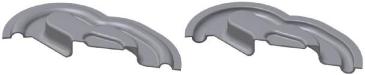
Obr. 2.17 Rozdíl v umístění brzdících žeber na výtažek
