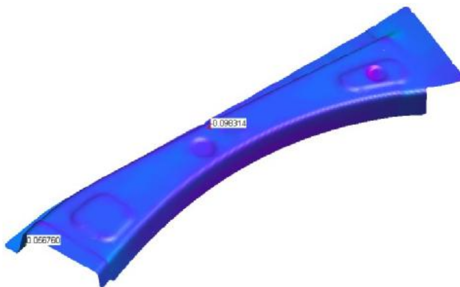
Obr. 3.8 Vizualizace výsledku ztenčení materiálu v programu AutoForm 4.06
