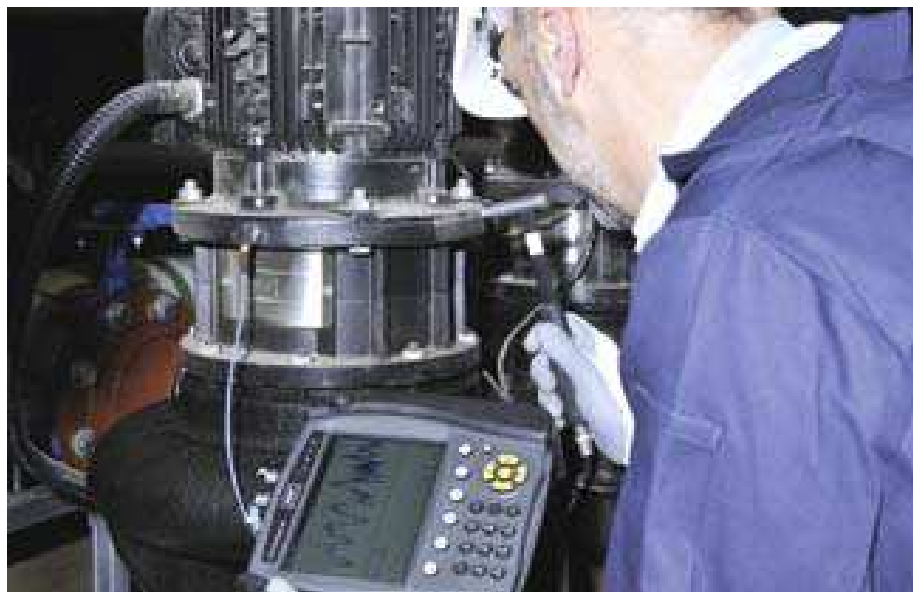
Obr.30 - SKF Microlog AX umožňuje rychlý sběr dat a analýzu. Velká obrazovka usnadňuje prohlížení při jakémkoliv osvětlení
