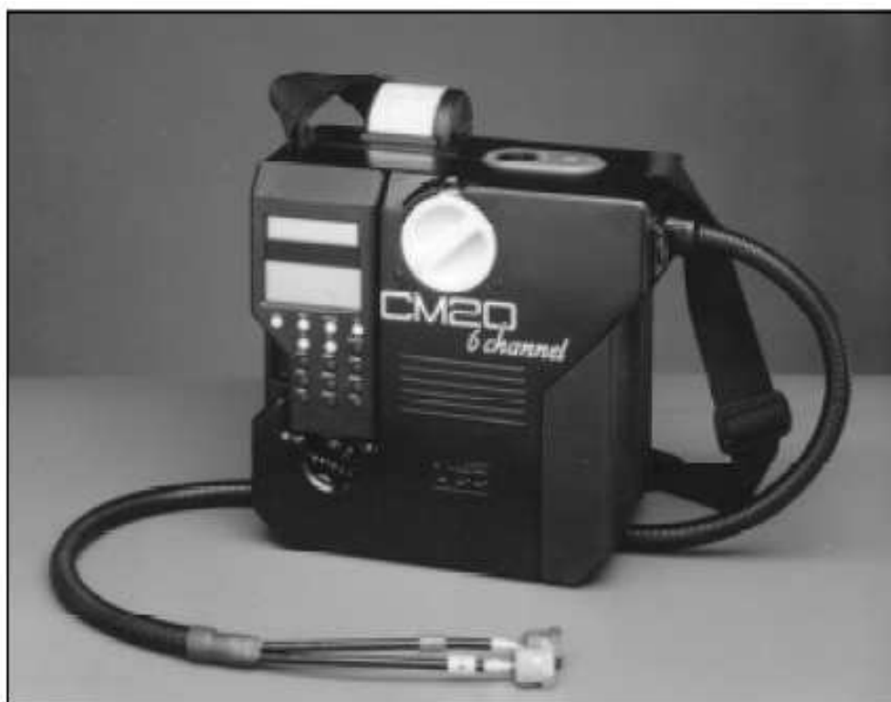
Obr.32 – Šestikanálový přenosný olejový analyzátor CM20
