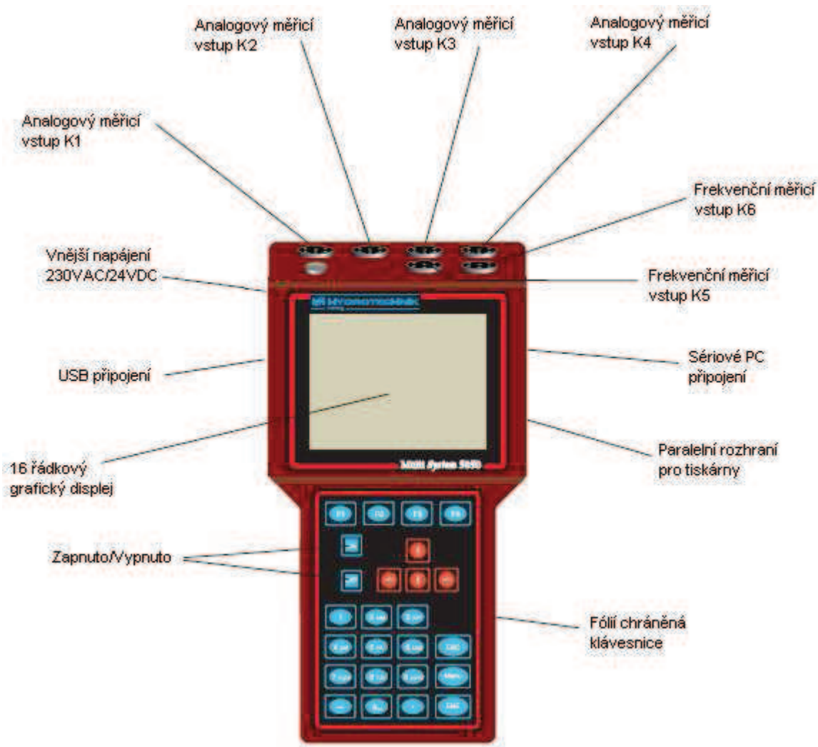
Obr. 7.6 Měřicí zařízení Hydrotechnik M5050
