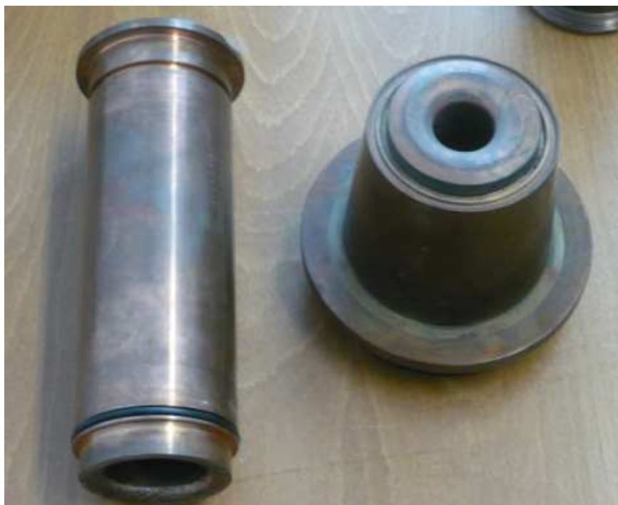
Obr. 2.1: Anodová a katodová část plazmatronu
