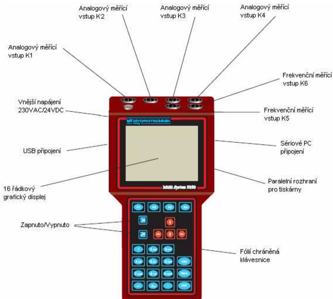
Obr. 4.3: Měřicí zařízení Hydrotechnik M5050
