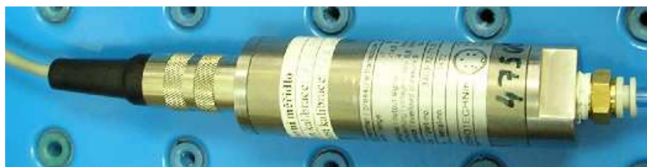
Obr. 4.4: Snímač firmy Hydrotechnik
