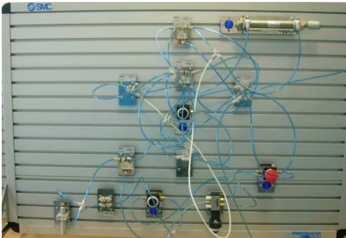
Obr. 4.2: Provedení ovládacího obvodu v laboratoři
