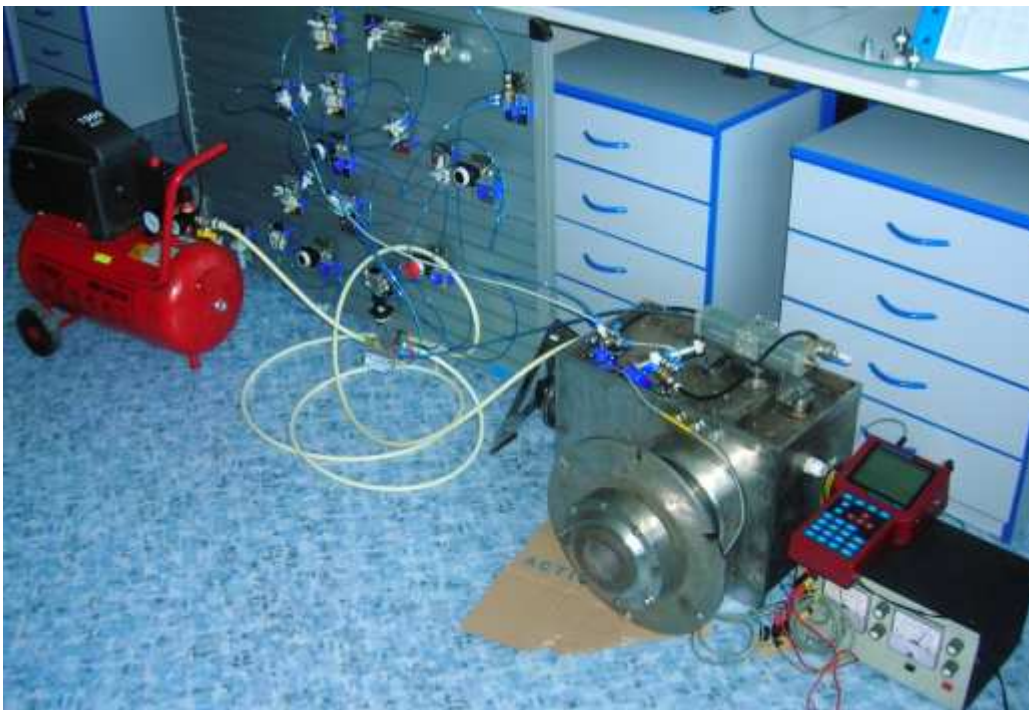
Obr. 4.1: Zapojení měřicího systému na plazmatron
