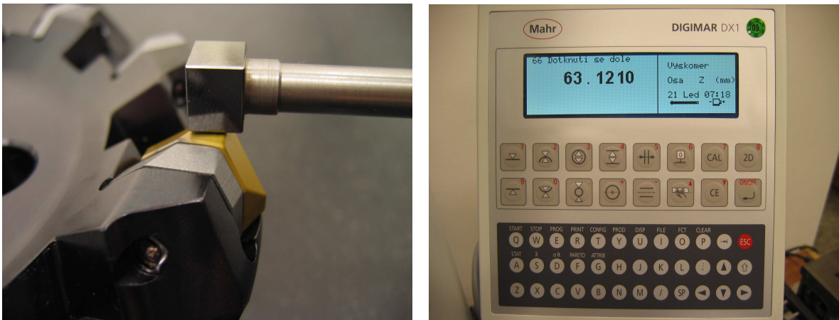
Obr.13 Měření výšky nástroje L ( vlevo – měřící dotyk; vpravo – naměřená hodnota)
