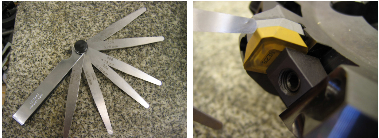
Obr. 15 Měření dotahu a (vlevo – spárové měrky; vpravo – detail měření)
