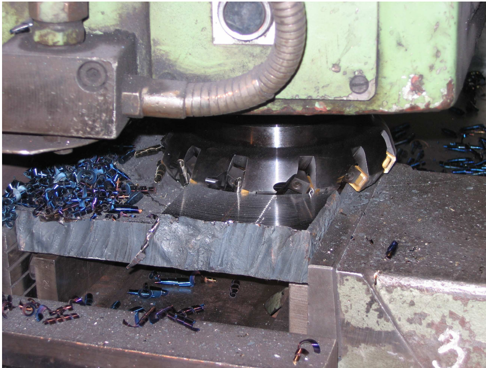
Obr. 27 Prototypová fréza při obrábění na frézovacím centru FCV 63 SCA
