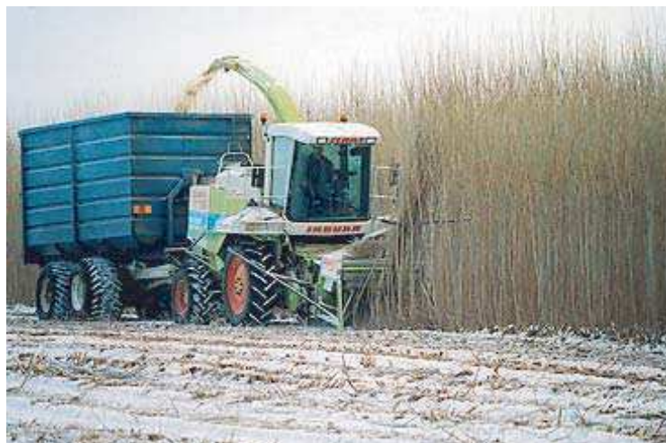
Obr. 7: Sečení sklízecí řezačkou [12]
