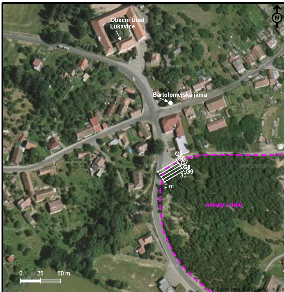
Obr. 1 Situace gravimetrických profilů. Profily G5 až G9 jsou vytyčeny v místě předpokládané polohy vodní šachty Vilemína.
