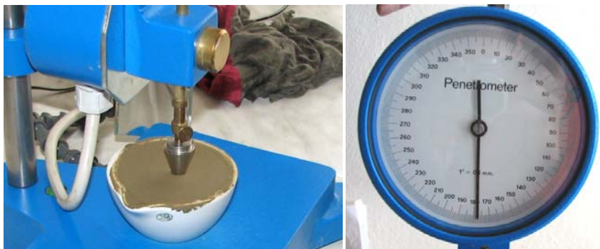
Obr. 2a: (vlevo) Kuželová zkouška - zaboření kužele do těsta; Obr. 2b: (vpravo) Penetrometr po zaboření
