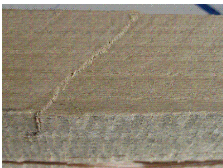
Obr. 5: Porušení bukového řeziva v tlakové oblasti
