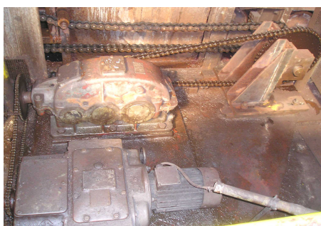
Obr. 19 Pohon pásu (vpředu pohon s variátorem, vzadu převodová skříň)
