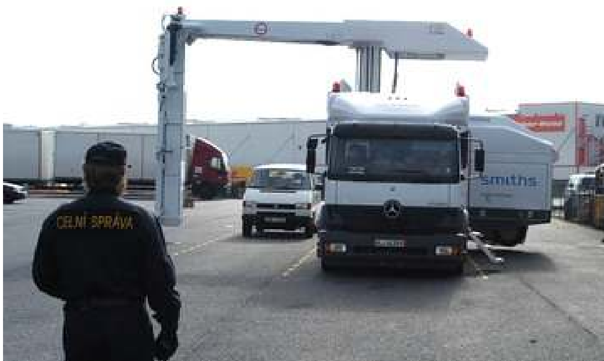
Obr.č.2 – nasazení mobilního velkokapacitního rentgenu při kontrolní činnosti
